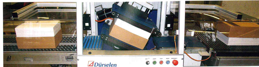
Beim Verpacken in Stülpschachteln übernimmt die Dürselen-Wendestation DS.02 das Umdrehen der Stapel, nachdem der Kartonboden übergestülpt wurde. Die starke physische Belastung der Mitarbeiter wird somit eliminiert.
