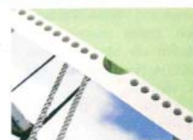
Perfekte Drahtkammlochbilder inklusive Daumenloch verlassen die Dürselen-Maschinenkombination, bestehend aus der PB.16D und der PB.18, bei IVS Abele.
