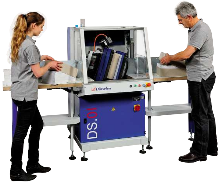
Rationelles Verpacken in Stülpkartons mit der Wendestation Dürselen DS.01.
