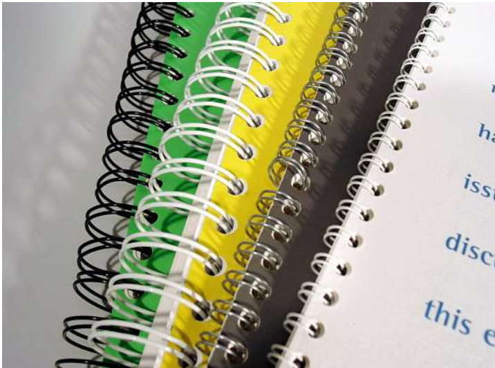
Effizient bei großen Mengen und Produkten mit einem Materialmix: Drahtkammlochung bohren anstatt stanzen.
