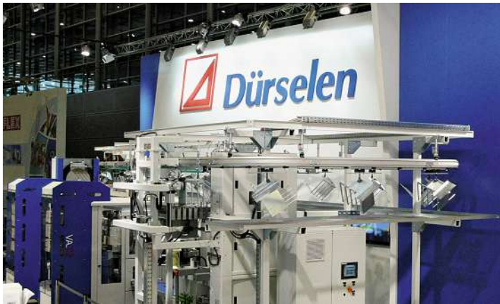
Der Verpackautomat Dürselen VA.02 wurde zur drupa mit einem neuen Hängebahn-Transport für Broschürenstapel gekoppelt.
