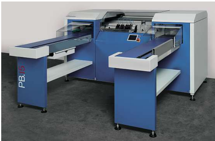
Der Bohrautomat Dürselen PB.15 für konstant hohe Leistung und vollautomatischen Arbeitsablauf beim Bohren von Drahtkammlochungen.
