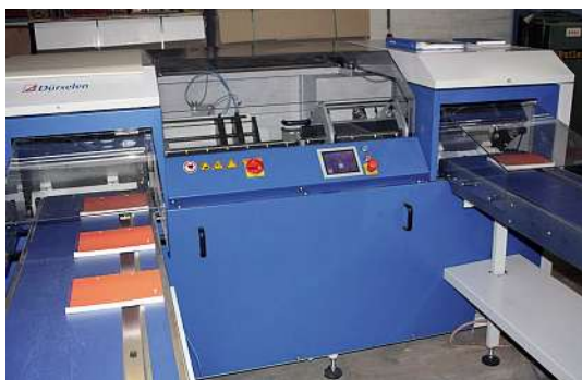
Der Papierbohrautomat PB.15 von Dürselen wird bei Beltz Druckpartner in Hemsbach inline mit der Klebebindeanlage betrieben.
