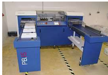
Das automatische Papierbohrsystem Dürselen PB.15 rüttelt und bohrt Stapel von losen Blättern, Stapel von gefalzten Bogen und Lagen, Stapel von klebegebundenen Produkten sowie Stapel von gehefteten Broschüren bis 50 mm Höhe (optional 75 mm) mit einer Leistung von bis zu 1.500 Takten/h für Abheftlochungen und bis zu 700 Takten/h bei Lochreihen für Drahtkammbindung.
