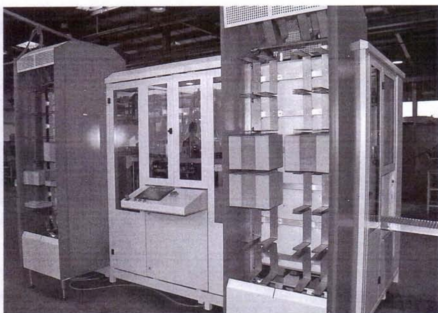
Der Kartonboden wird über den ausgerichteten Stapel gezogen, nach einer Wendung wird der Deckel zugeführt. FOTOS: BIN
