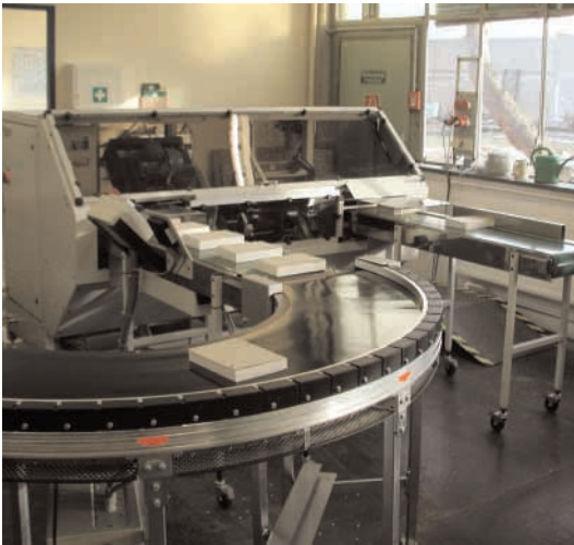
Das Inline-System zum Bohren und Eckenrunden aus dem Hause Dürselen sorgt bei der C4-Bundesdruckerei für eine rationelle und vor allem termingerechte Weiterverarbeitung der Loseblatt-Flugpläne.
