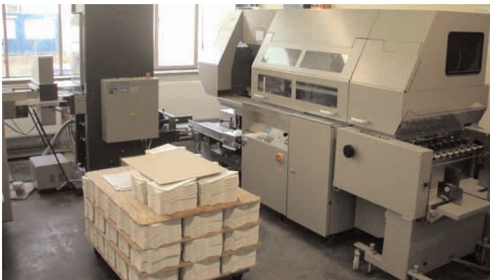
Klebbinden läuft über eine komplett ausgestattete Anlage von Horizon.
