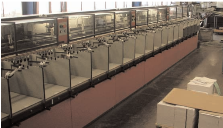
Zusammentragen und Broschürenfertigung erfolgen über ein System aus dem Hause Theisen & Bonitz in Burscheid.
