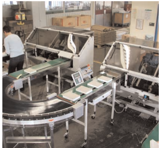
Das Inline-System zum Bohren und Eckenrunden aus dem Hause Dürselen sorgt bei der C4-Bundesdruckerei für eine rationelle und vor allem termingerechte Weiterverarbeitung der Loseblatt-Flugpläne.
