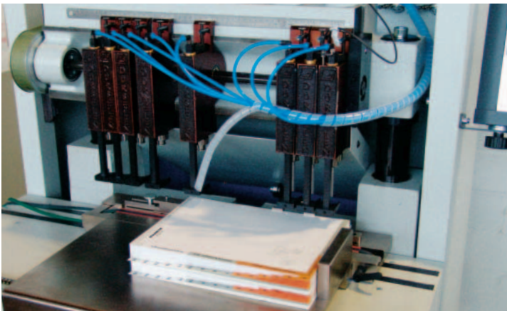
Acht Bohrköpfe werden viermal positioniert und sorgen so für 34 Löcher auf der Längsseite von zum Beispiel einem DIN A4-Block.
